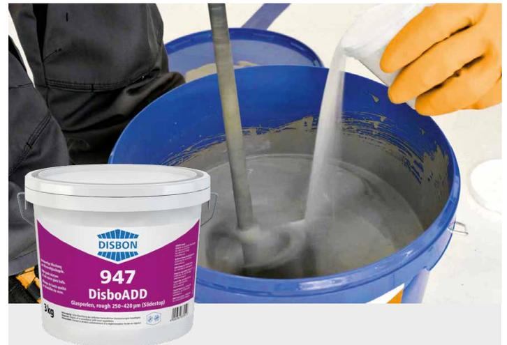
Durch den Einsatz der **DisboADD 947 Glasperlen** (Slide Stop) lässt sich die Rauheit des Bodens variieren. Somit können Sie eine raue und rutschhemmende Oberflächen erzielen. Die Glasperlen werden vor der letzten Beschichtung in das Material eingerührt und anschließend mit aufgerollt. Da sie transparent sind, fügen sie sich harmonisch in das Oberflächenbild ein.
